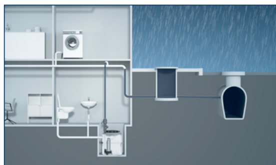
UNILIFT APG jako element agregatu wewnątrz budynku
